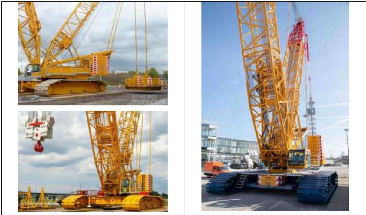
Foto di gru tipo Demag CC2800 che può essere utilizzata nel cantiere in oggetto
